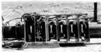
图 20 径向缩径设备
