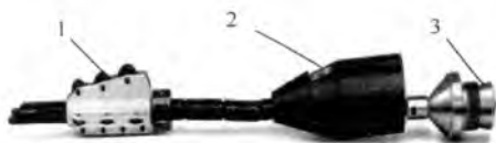
图 16 静拉碎（裂）管工具
